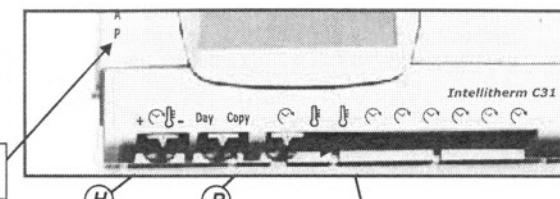
**2 – Mutați tastă P în poziția 2 și fixați temperatura de economie cu ajutorul tastei H**
